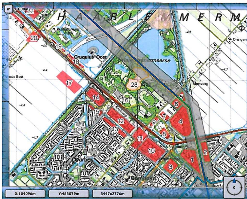
Figuur 9. Kilometer leiding (groen) met het hoogste groepsrisico. De grijze zone rond de leiding is het invloedsgebied.
