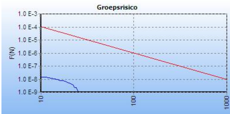
Figuur 5.1 FN curve voor W-529-12 van N.V. Nederlandse Gasunie voor de kilometer tussen stationing 0.00 en stationing 200.00
