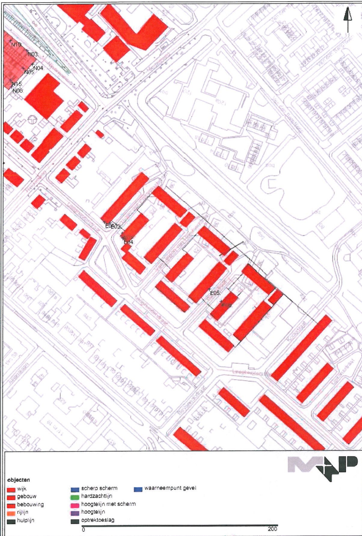
figuur 10 rekenmodel Ewijkstraat wegverkeerslawaaai 30 km/uur-wegen
