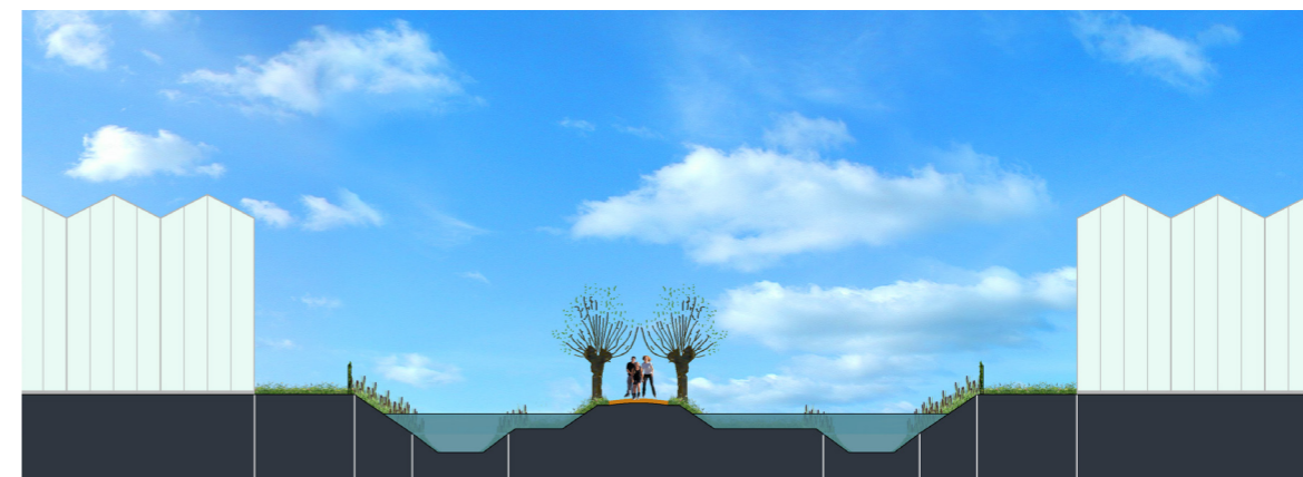
Voorbeeld dwarsprofiel bij piekwaterberging
