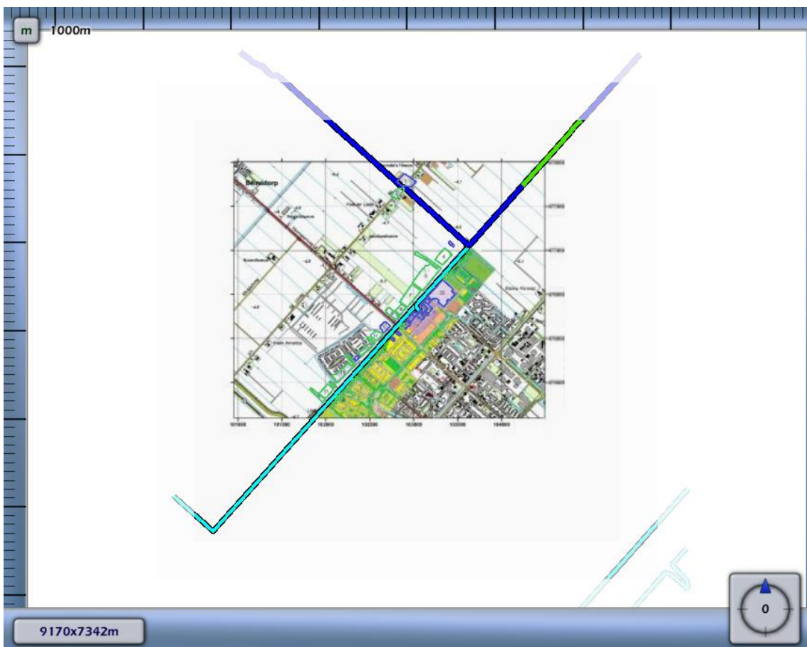
Figuur 4.6 Kilometer leiding behorende bij de maximale overschrijding van de FN-curve voor W-532-12 van N.V. Nederlandse Gasunie
