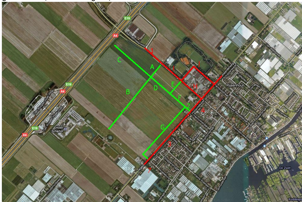
Afbeelding 3.2 Voertuigbewegingen van en naar het plangebied met nummering (groen: nieuwe weg, rood: bestaande toewerwegen naar plangebied)
