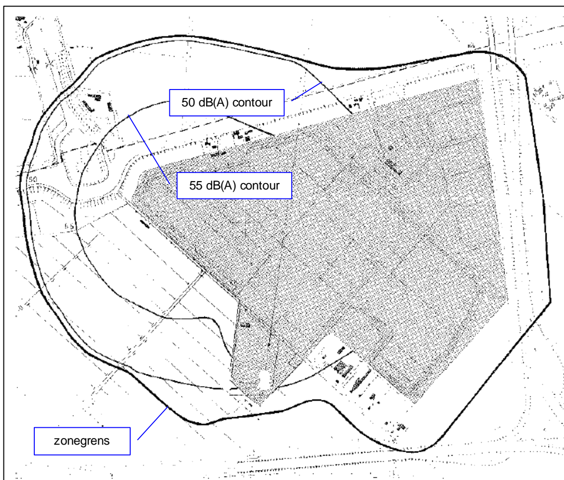
Figuur A Originele zonecontour industrieterrein
