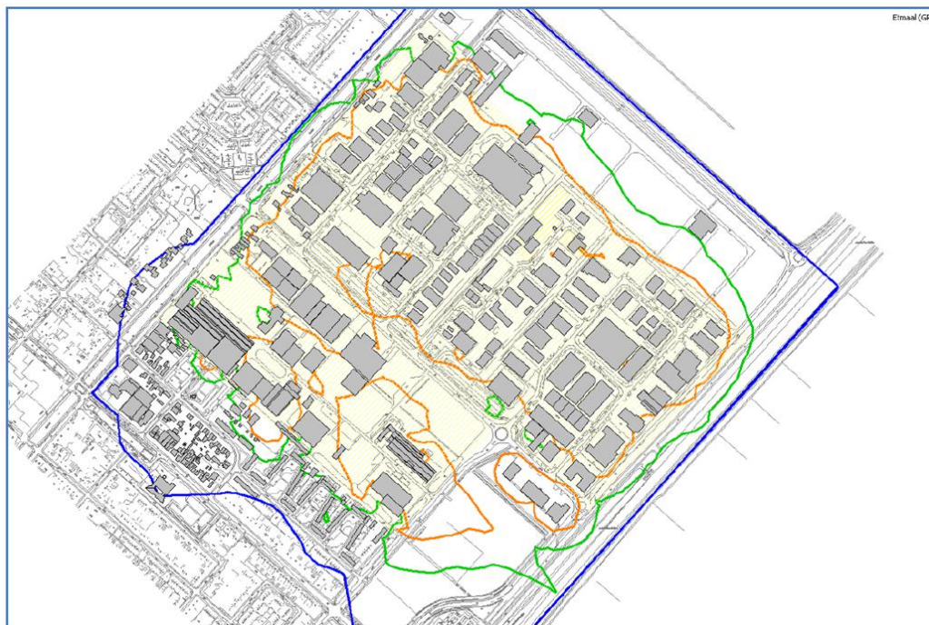
Figuur 5.5 de 50dB(A)- (groen) en 55 dB(A) (oranje) zijn de berekende contouren en de blauwe lijn betreft de vastgestelde geluidzone 50 dB(A)
