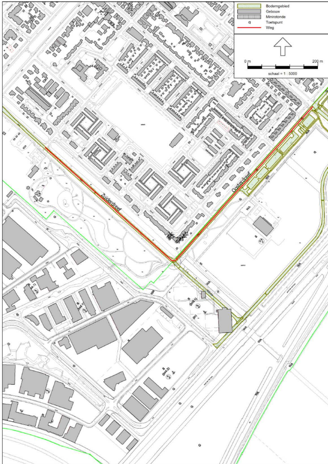
Wegverkeerslawai - RMW-2012, [versie van Stationsgebied - Nieuw Vennep reconstructie Zuiddreef bestaand], Geomilieu V2.13
