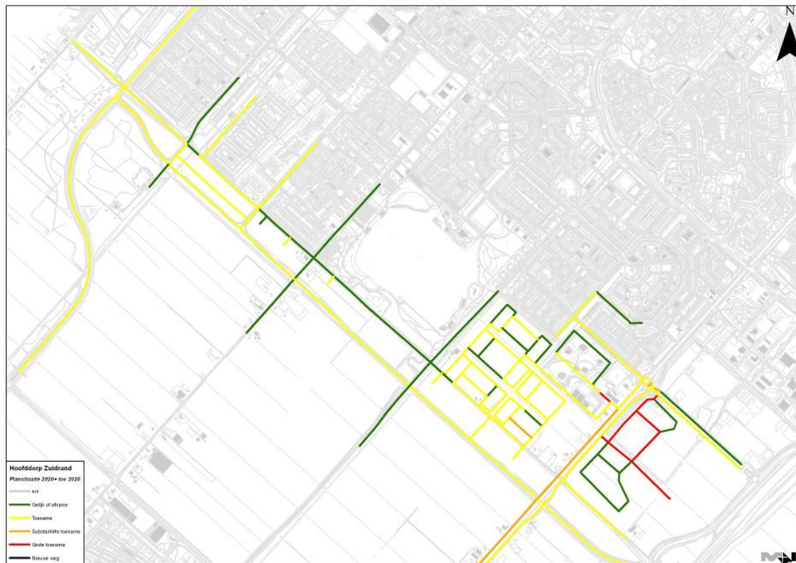
Figuur 8.5 Toename geluidsbelasting plansituatie 2020+ versus basisalternatief, op basis van de verkeersintensiteiten (groen is gelijkblijvend of afname, geel is toename <1,5 dB, oranje: significante toename 1,5 – 3 dB, rood: grote toename: >3 dB)
