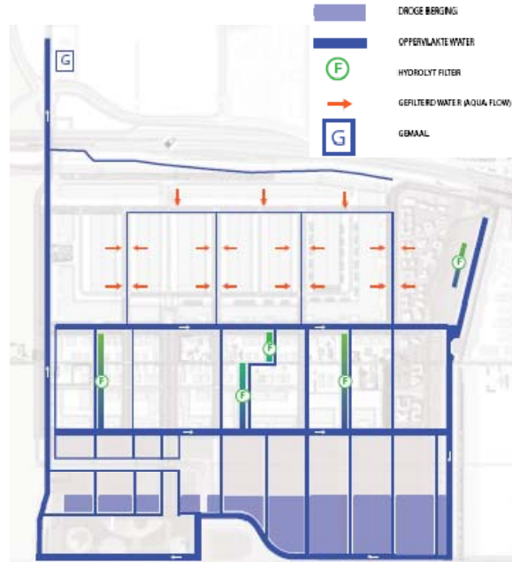
Figuur 4.10 Watersysteem met aqua flow
