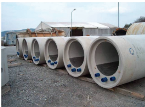
Afb: Rioolbuis met een rioolcollector in de betonbuis
