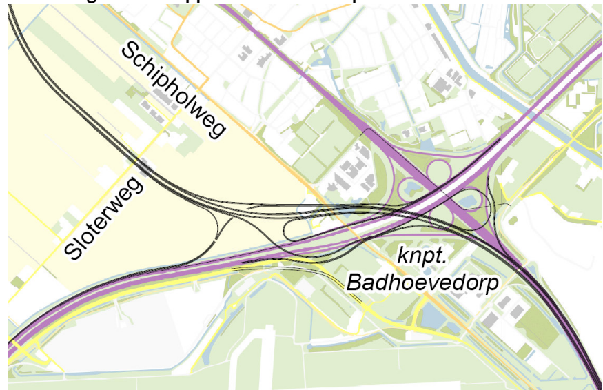
Afbeelding 2.7. Knooppunt Badhoevedorp - klaverturbine
