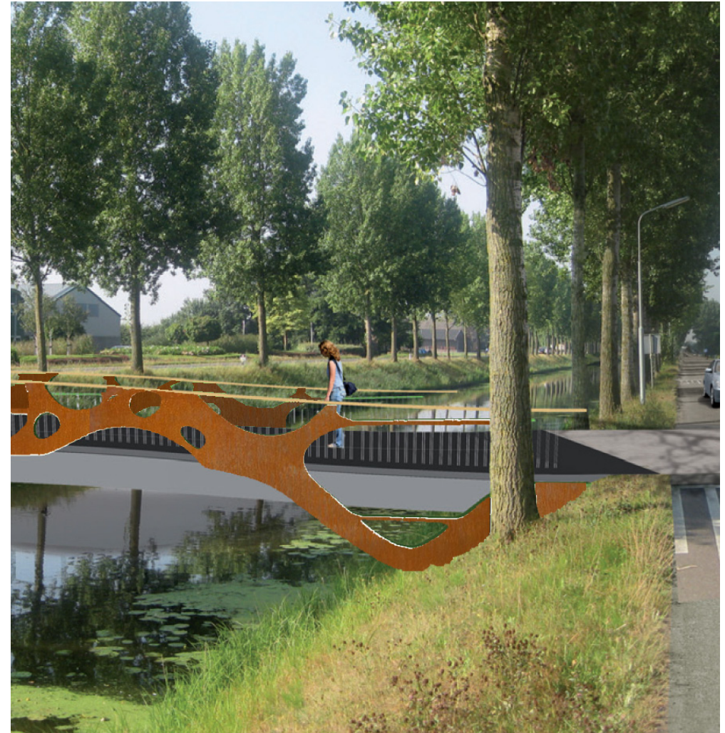
voorbeeld van een mogelijke parkbrug in de familie van parkbruggen en simpele toevoeging van Cortenstaal (onderhoudsvrij) kan elke standaard brug sieren...
