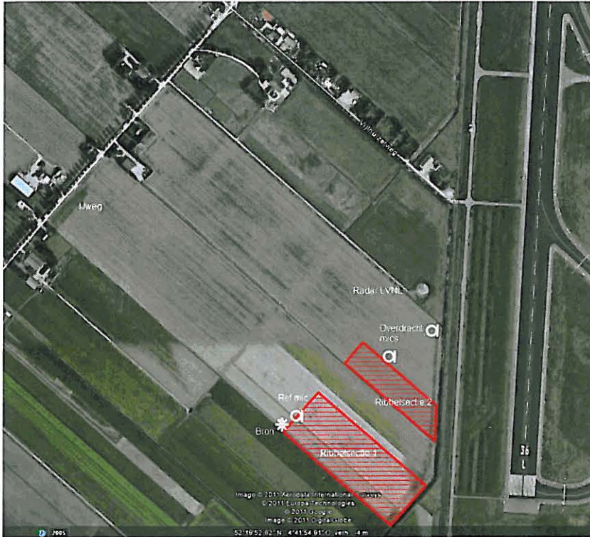
Figuur 2 De ribbelsecties bij de Polderbaan ten tijde van de meting (rood gearceerd), locatie van de geluidbron en microfoonposities.
