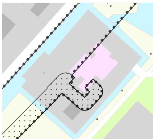
Tracé ondergrondse 150 kV hoogspanningsverbinding
